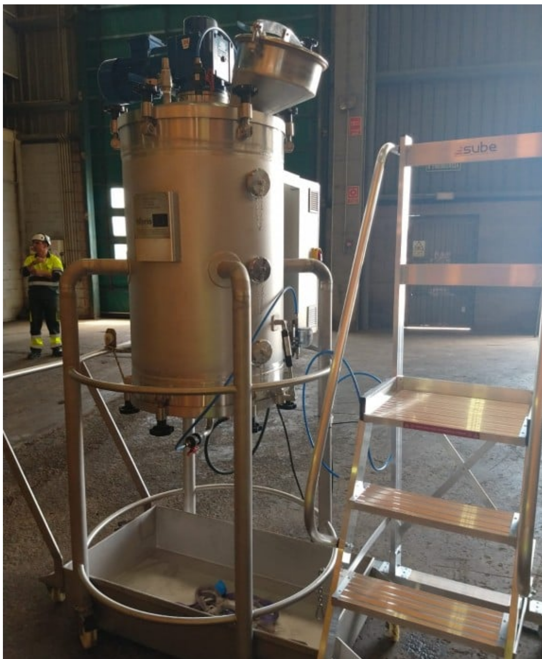
Reactor pilot de producció de biopesticides a partir de residus urbans. Foto: GICOM.
